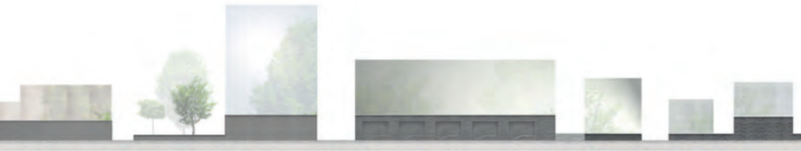
Kontrast von Sockel- und Hauptfassade: massiv/dunkel/matt (Sockel) vs. leicht/hell/glänzend (OG)
