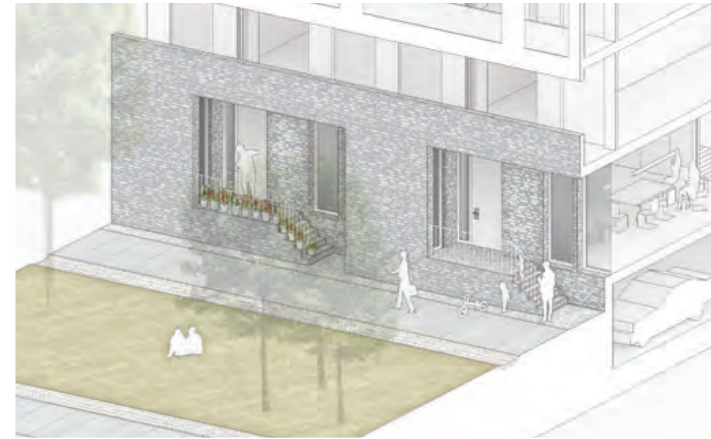
Nordseite, West- oder Ostseite: erhöhter Eingang mit individuellem Vorbereich; Beispiel: Typologie Wohnhof an der Promenade
