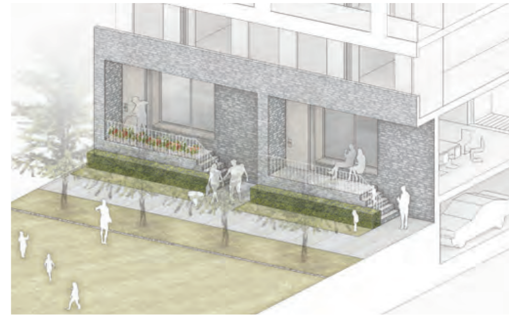
Nordseite, West- oder Ostseite: erhöhter Eingang mit begrüntem Vorbereich auf Straßenniveau; Beispiel: Wohnhof an den Wiesenterrassen
