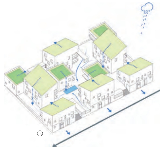
Axonometrie der Regenwassermaßnahmen
