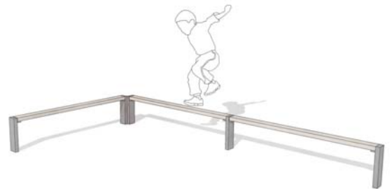
Aneinanderreihung der Einzelemente zum Koppelzaun
