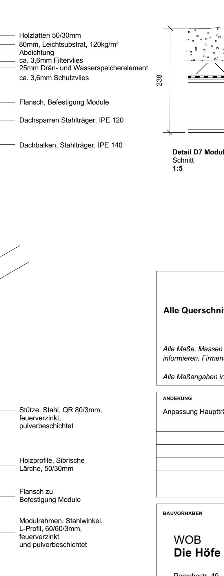
Detail D7 Module E mit Attika aus Stahl Schnitt 1:10
